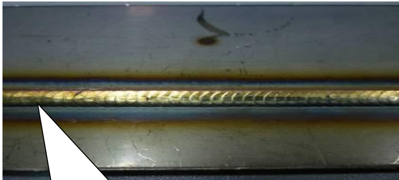
不锈钢填丝焊的焊缝成形
