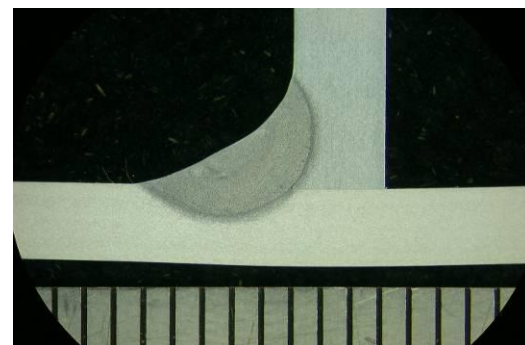
铝TIG自动填丝焊缝断面熔深形状
