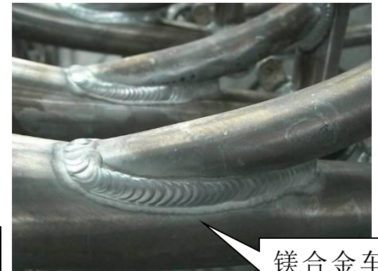
镁合金车架的机器人TIG焊接
