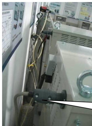
两台焊机加装交流协调连线
