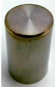
不锈钢薄板筒体TIG中频脉冲自熔焊
