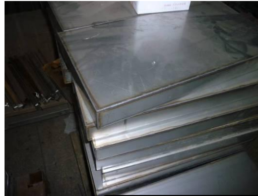
不锈钢TIG低频脉冲自熔焊的焊缝成形
